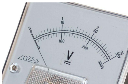
Rysunek 2.1: Przykład woltomierza analogowego klasy K=2.5, posiada on trzy zakresy pomiarowe.
